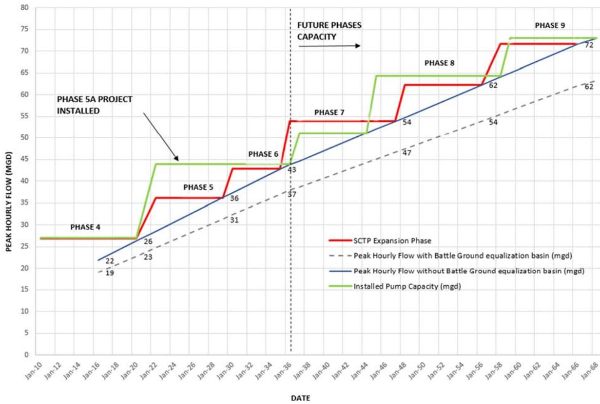
Figure 11. Effluent Pump Phasing Capacity
